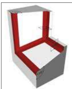
4. Rekonstruierte Fensterschräge mit zugehöriger Bemalung.
