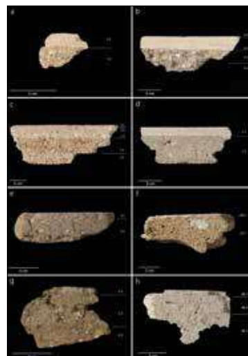
1. Selezione di campioni di intonaco analizzati. A sinistra, superficie del campione con decorazione pittorica; a destra, taglio petrografico in sezione.
