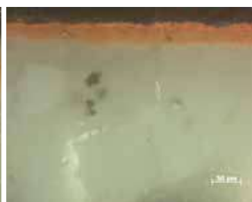
6. Micrografia del campione 157.014.125: dettaglio della parte più superficiale (Vis, luce incidente; PLM). Si noti in superficie il sottile strato a base di cinabro.
