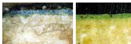
5-6. Sezione stratigrafica di un blu egiziano e di una terra verde (100X). Sezione stratigrafica di un blu egiziano e di una terra verde (100X).
