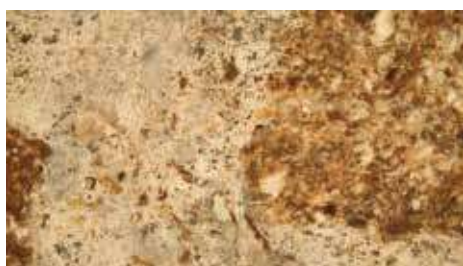
5. Composizione della sezione sottile della malta (ingrandimento 10X).
