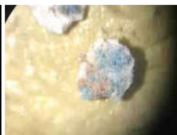
4. Campione visto al microscopio: blu egiziano.
