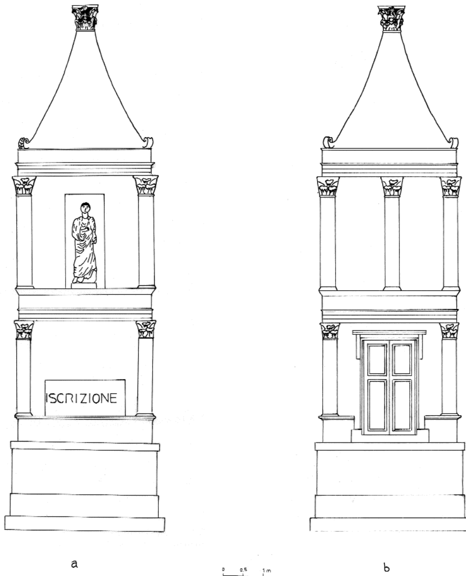
Fig. 30. Ipotesi di ricostruzione del monumento n. 7: lato frontale ovest (a) e lato meridionale (b) (ricostruzione: F. Negretto, disegno: G. Giannotti).
