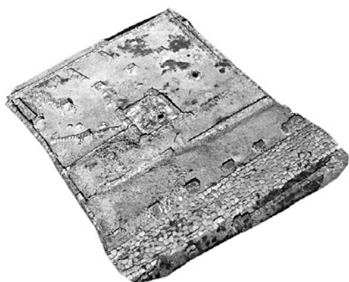
Fig. 5. Modello di superficie con sovrapposizione della foto da aquilone.
