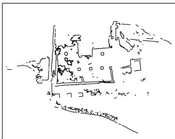
Fig. 7. Piano di sezione passante la nuvola di punti per la creazione della planimetria del sito.
