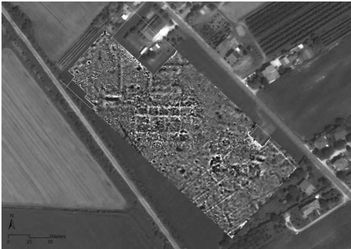
Fig. 4. Indagine geomagnetica con gradiometro al cesio (in collaborazione con H. Becker, Becker Archaeological Propection). Mappa del gradiente verticale in seguito al filtraggio dei dati.
