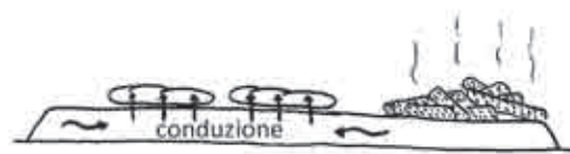
Fig. 20. Modalità di trasferimento del calore sulla piastra di cottura
